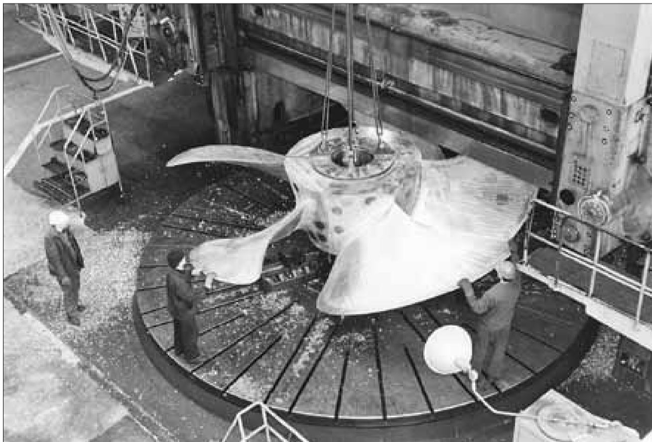
■ На «Звездочке» изготовлены 5-метровые гребные винты типа «Азинод»
